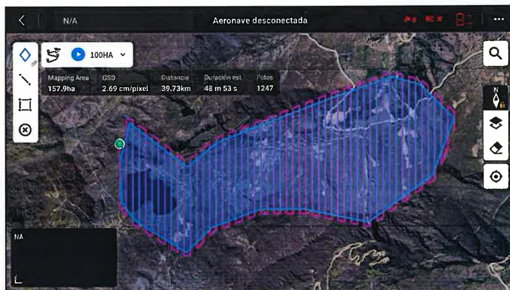
IMAGEN 2. Ejecución de vuelos Dron y seguimiento a su recorrido conforme el perfil generado por un DEM.
